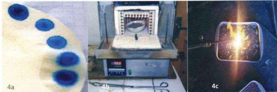
Figure 4 : Essai de bleu de méthylène et de combustion sur les schistes houillers
